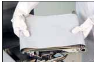
Transportbandeinheit einfach vom Motor und Rahmen trennbar (Klick-System).
