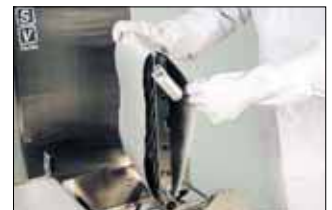
Transportbandeinheit einfach vom Motor und Rahmen trennbar (Klick-System).
