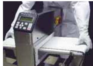
Klick-System zur Montage/ Demontage des Transportbandes
