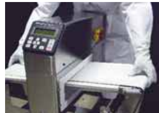
Klick-System zur Montage/ Demontage des Transportbandes
