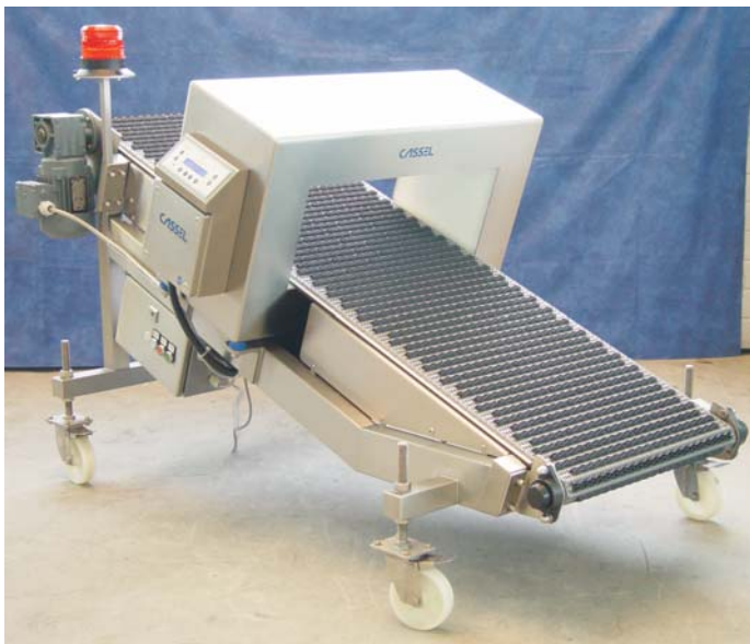
Ansteigendes Band nach einer Schlauchbeutelmaschine
